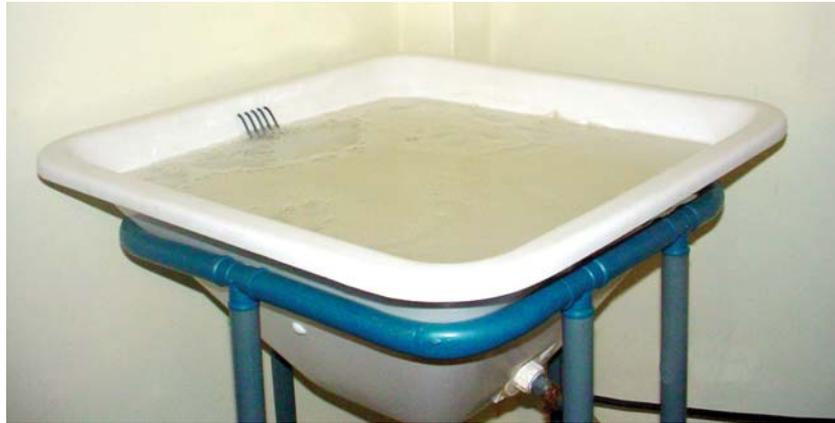
Conectar el equipo a la toma corriente de 110 voltios. La llave de descarga de la solución debe estar cerrada completamente.
